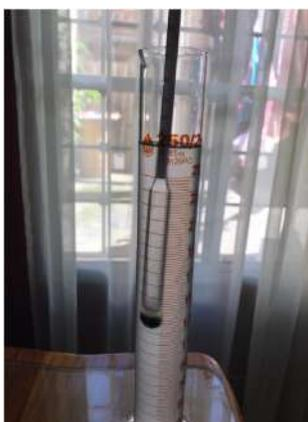
**Figura 5.** Alcoholímetro, instrumento para medición de porcentaje de alcoholes
